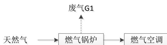
图 5-1 燃气空调运行工艺流程图
