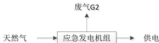
图 5-2 应急发电机运行工艺流程图
