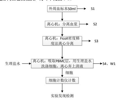
图 5-1 细胞分离工艺流程图
