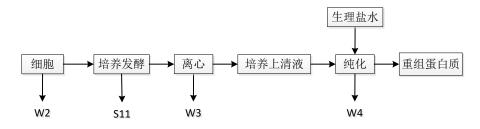
图 5-3 重组蛋白质小试生产和纯化工艺流程图
