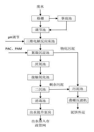
图 7-1 本项目自建污水处理站工艺流程图
